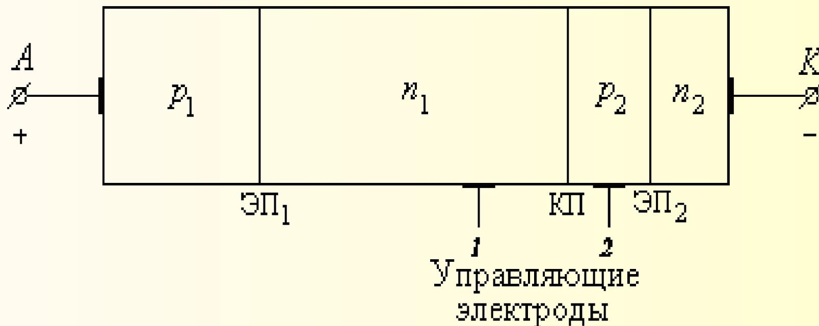
При создании тиристора в качестве исходного материала выбирается подложка **n-** или **p-типа**. Типичный профиль легирующей примеси в диффузионно-сплавном приборе показан на рисунке. В качестве исходного материала выбрана подложка **n-типа**. Диффузией с обеих сторон подложки одновременно создают слои **p1** и **p2**. На заключительной стадии путем сплавления (или диффузии) с одной стороны подложки создают слой **n2**. Структура полученного тиристора имеет вид **p1+-n1-p2-n2+**.
