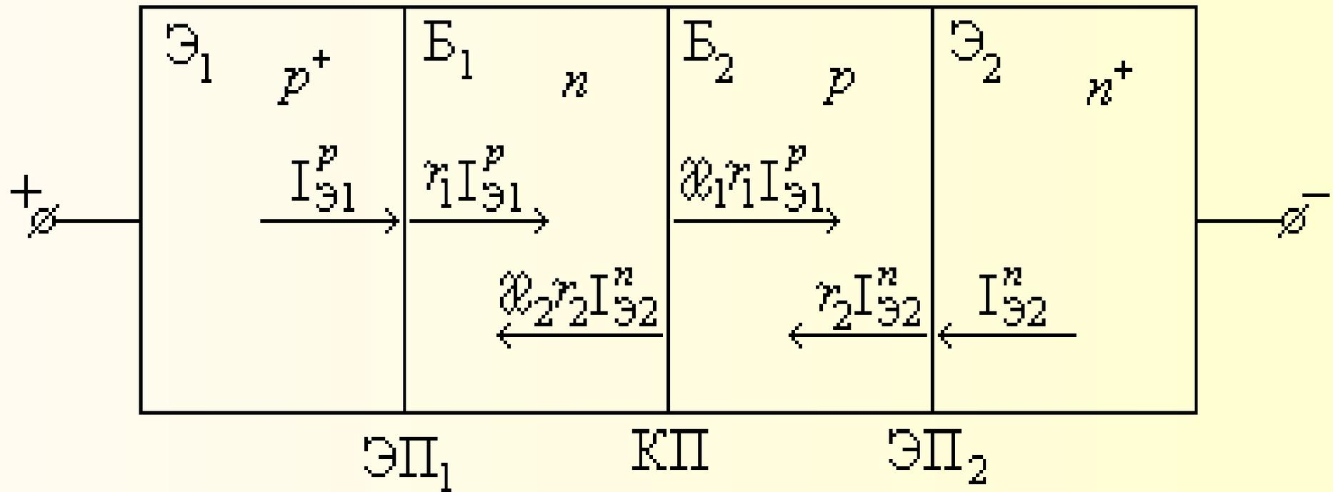
Дырки из первого эмиттера инжектируются в первую базу через первый эмиттерный переход, смещенный прямо. Коэффициент инжекции  $\gamma_1$ . Затем они диффундируют до коллекторного перехода. Коэффициент переноса  $\alpha_1$ . Дырки в первой базе являются неосновными носителями, они экстрагируются через обратно смещенный коллекторный переход во вторую базу. Коэффициент передачи Э<sub>1</sub>-Б<sub>2</sub> равен  $\alpha_1 = \gamma_1 \alpha_1$ .
