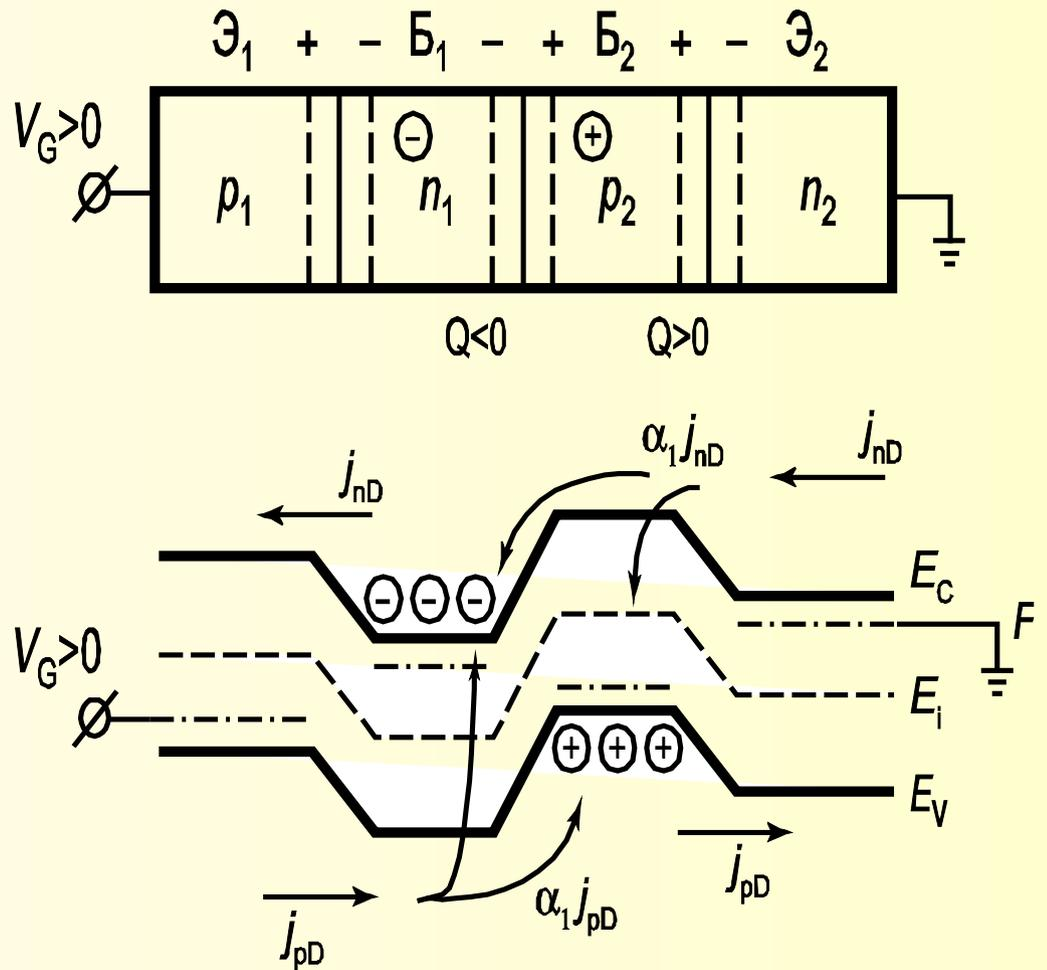
Таким образом, тиристор имеет два устойчивых состояния: малый ток, большое напряжение, высокое сопротивление и большой ток, малое напряжение, низкое сопротивление. Переход тиристора из закрытого состояния в открытое связан с накоплением объемного заряда в базах из-за роста коэффициента передачи эмиттерного тока.
